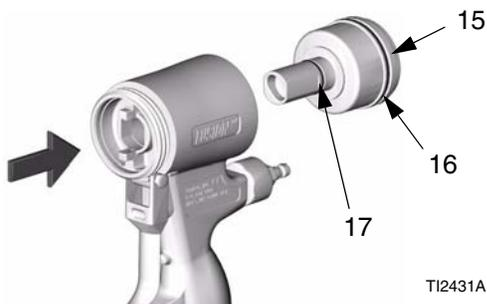
**6.** Lubrique abundantemente las juntas tóricas del pistón. Vuelva a colocar el pistón. El eje está provisto de chavetas para facilitar la instalación. Empuje firmemente para asentar el pistón.
