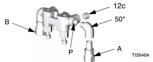
5. Conecte las mangueras A y B en los racores giratorios A y B.
