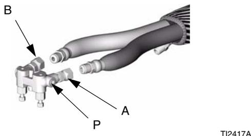
4. Aplique sellador de roscas en los tapones (12c), los codos (50\*), y las roscas macho de los racores giratorios (A, B). Instale los codos (50\*) en las entradas opcionales (P), dirigidos hacia abajo. Instale los racores giratorios (A, B) en los codos. Asegúrese de instalar el racor giratorio A (más pequeño) en el lado A. Instale los tapones en los lugares donde había racores giratorios. Apriete todas las piezas a 235-245 in-lb (26,6-27,7 N•m).
